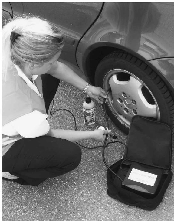
*Das Reparaturmittel wird über eine Flasche mit integriertem Befüllschlauch in den Reifen gefüllt. Danach wird der Reifen mittels eines kleinen Kompressors wieder aufgepumpt und das Loch abgedichtet*
