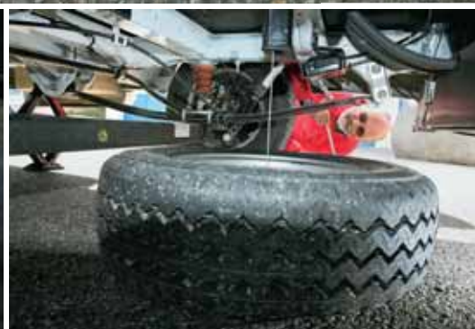
Erster Schritt: Das Ersatzrad hängt an einem Stahlseil und lässt sich so langsam und gefahrlos herunterkurbeln.
