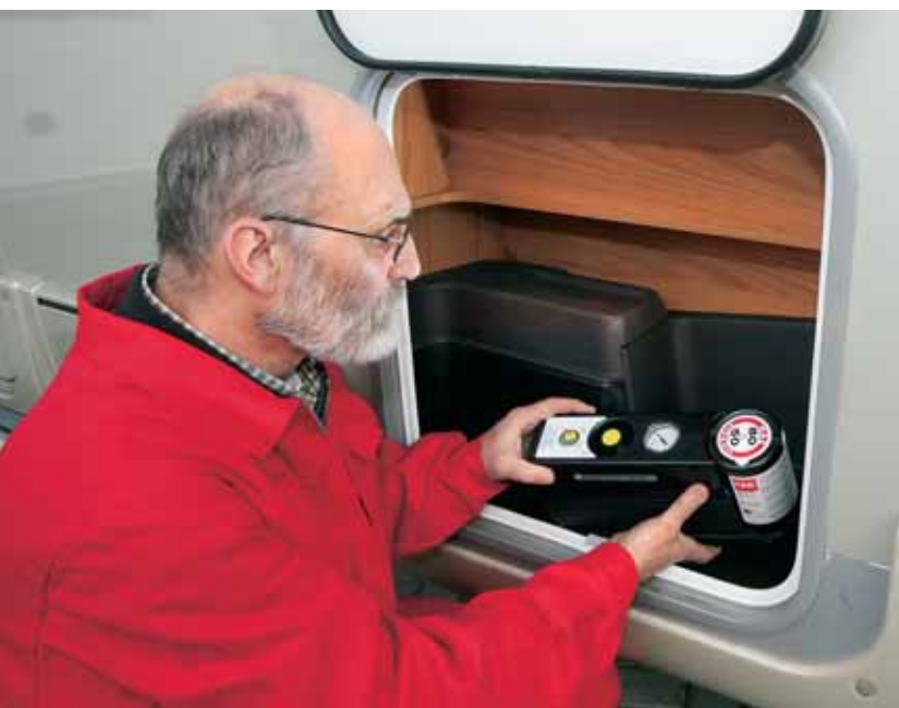
Flickzeug: Die Verwendung eines Pannens-Sets ist natürlich verlockend – im Vergleich zum Ersatzrad sind das Gewicht und der Platzbedarf minimal.
