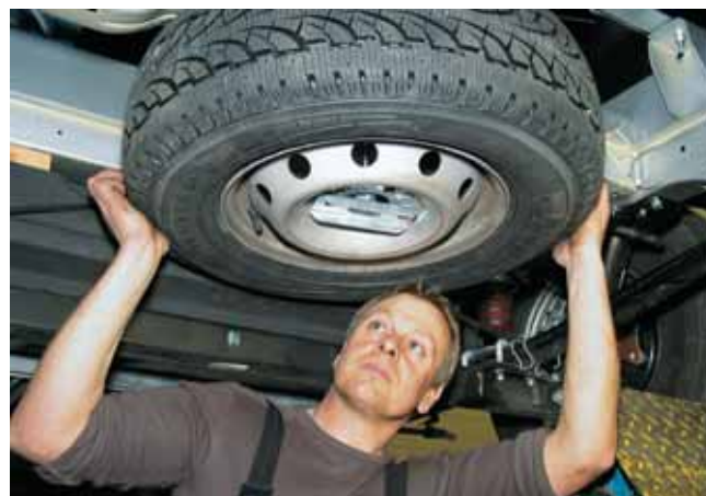
Stabilität: Das Ersatzrad wird an einem Blechteil aufgehängt, das gleichzeitig zentriert und mit einem Zapfen für den Lochkranz für Halt sorgt.
