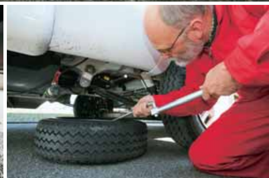
Zweiter Schritt: Mit der Kurbel des Bordwagenhebers zieht man das Rad unter dem Fahrzeug vor.
