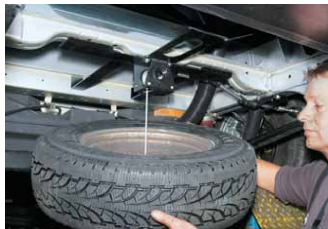
Ergonomie: Die Winde, die das Zugseil auf- und abwickelt, wird im Gegensatz zur Fiat-Lösung bequem von außen bedient.
