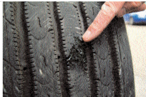
4. Nun wird das Dichtmittel eingefüllt und der Reifen auf Druck gebracht. 5. Die defekte Stelle ist sofort dicht und hält. 6. Die Reinigung ist einfach, nichts klebt
