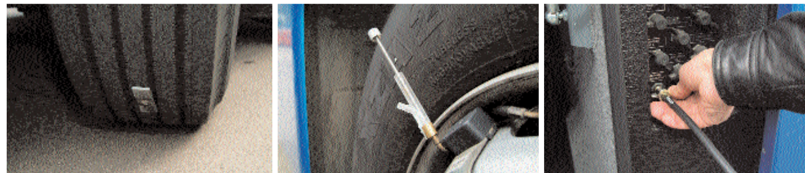
1. Ein 8-mm-Bolzen wird eingefahren und anschließend herausgezogen. 2. Der Fahrer setzt den Ventileinsatzdreher auf und schließt den Luftschlauch an (3.).
