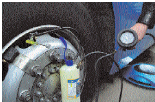
4. Nun wird das Dichtmittel eingefüllt und der Reifen auf Druck gebracht. 5. Die defekte Stelle ist sofort dicht und hält. 6. Die Reinigung ist einfach, nichts klebt
