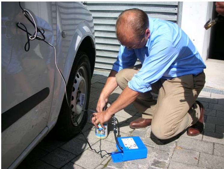
Versuchsfahrzeug A: Einsatz von PREMIUM-SEAL Dauer mit AIO 3 Min. 30 Sek.
