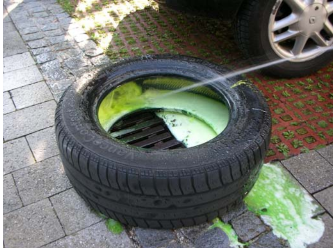
Problemlose Reinigung und Entsorgung von PREMIUM-SEAL – Dauer ca. 3 Min.
