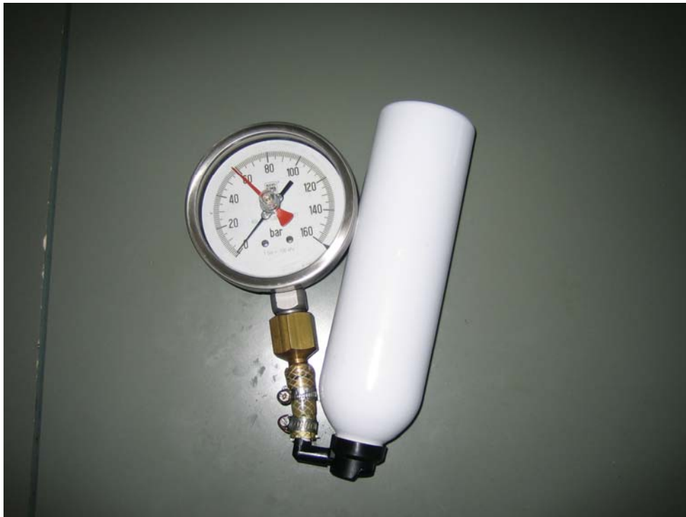
Anschließend wurde der Sprühkopf mit einem Manometer verbunden und der Druck bei 80°C gemessen.
