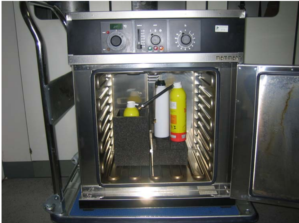
Die Druckgasflaschen wurden bei 80°C im Trockenschrank 24h gelagert.
